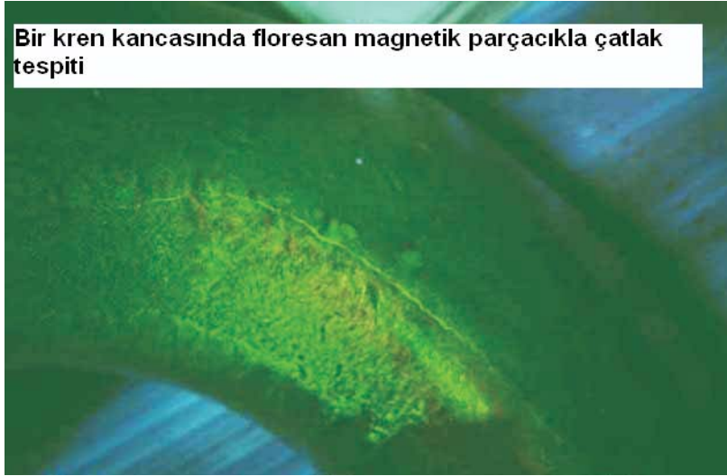
Şekil 12. Magnetik Parçacıkla Testte Çatlak Tespiti (3)
