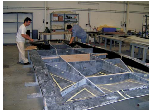
Şekil 7. Şasi Bölümlerinin Aracın Üzerine Yerleştirilmesi ve Desteklerin Atılması
