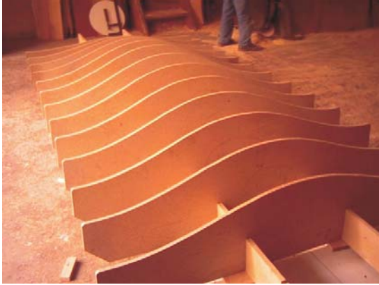
Şekil 2. Bilgisayar Destekli Modelin Üretime Hazırlanması ve Model İmalatı
