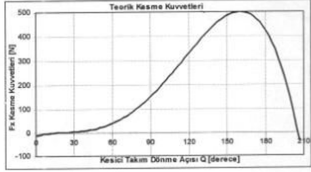
Şekil 7. Küresel uçlu parmak freze kesicisi ile 30° eğimli yanal işlenmesi için deneysel ve teorik F x kuvvet değerleri.
