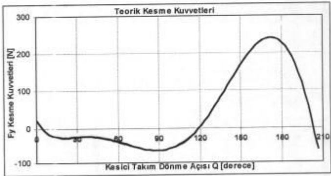
Şekil 8. Küresel uçlu parmak freze kesicisi ile 30° eğimli yanal işlenmesi için deneysel ve teorik F y kuvvet değerleri.
