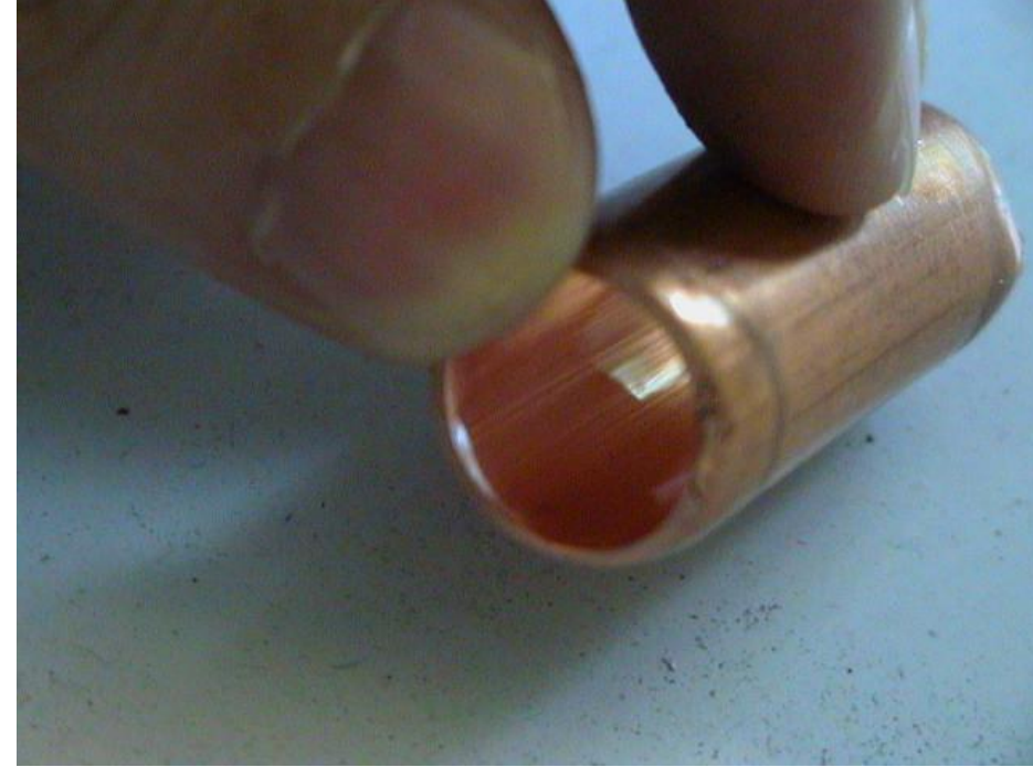
Azot altında kaynak yapılmış bakır boru
