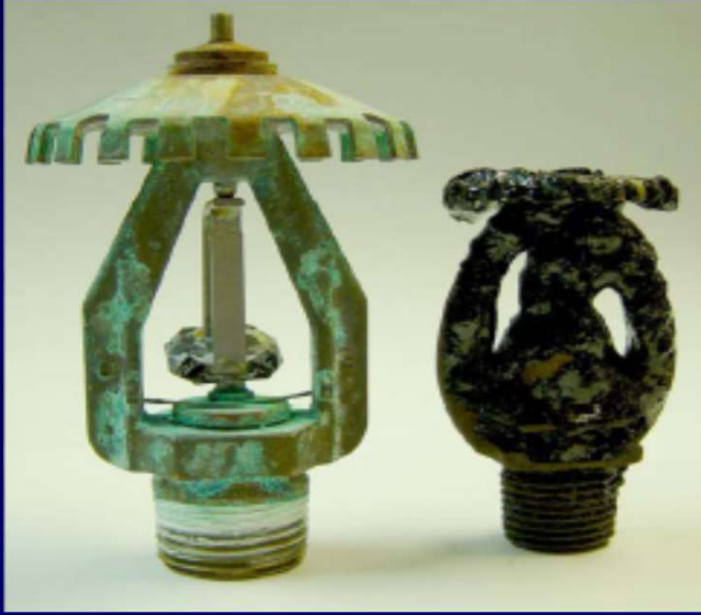
KOROZYONA MARUZ KALMIŞ SPRINKLER
