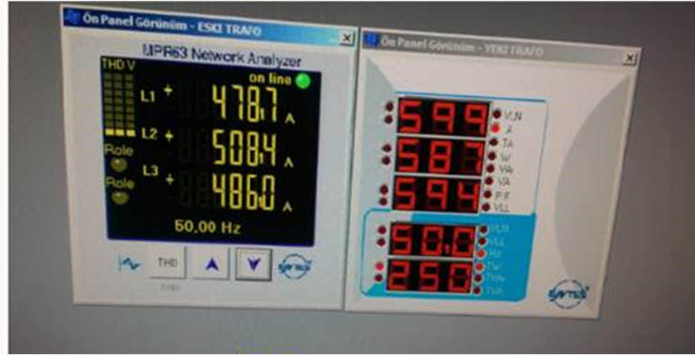
Resim 4: Mevcut Durumda Molalarda Harcanan Enerji Miktarını Gösteren Enerji Analizör Görüntüsü
