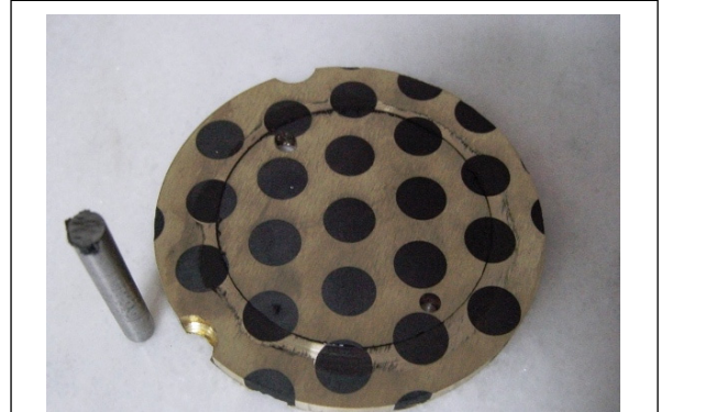
Şekil 3. Aşınma Deneylerinde Kullanılan Kendinden Yağlamayı Sağlayan Grafitli SAE430B Mangan Bronz Disk ve Pim Aşınma Çifti
