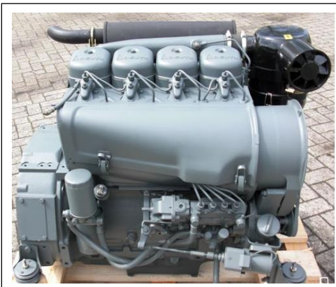
Şekil 5. Deneylerde Kullanılan Deutz Magirus Marka ve F4L912 Model Dizel Motor
