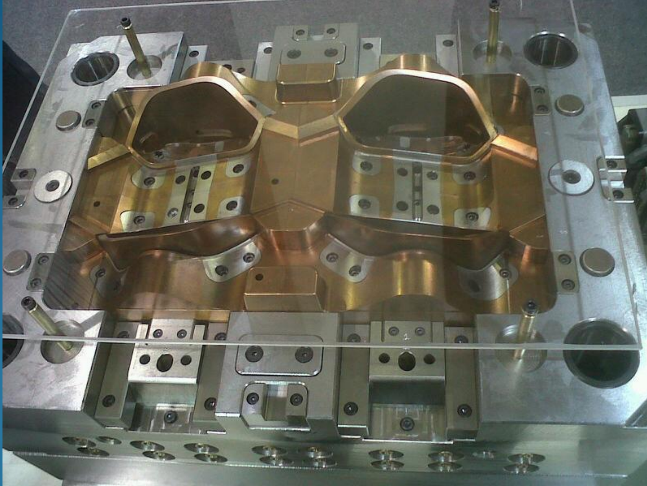
Resim: Arka Stop Sinyal Reflektr Enj. Kalıbı, Kalıp Ağırlığı: 2 Ton
