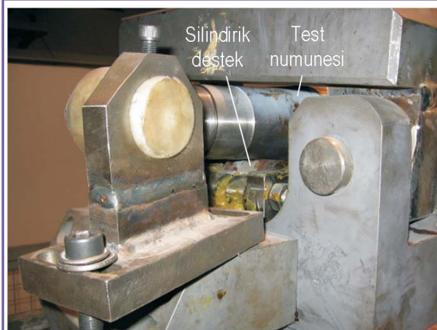
Şekil 6. Test Cihazında Kullanılan Silindirik Desteğin Ayrıntısı
