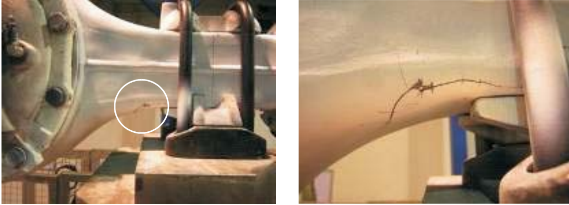
Şekil 3. Gövde Numunesinde Yorulma Hasarı Örneği
