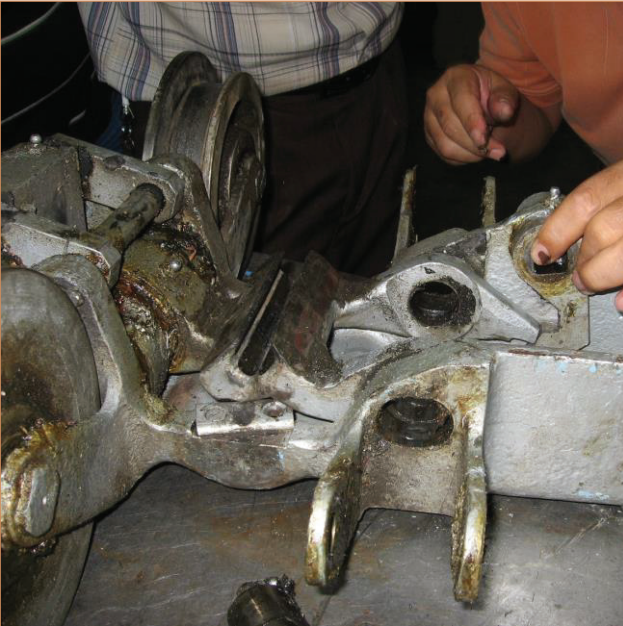
Fotoğraf 17. Kilit Mekanizmasının Boşta Olması Durumu
