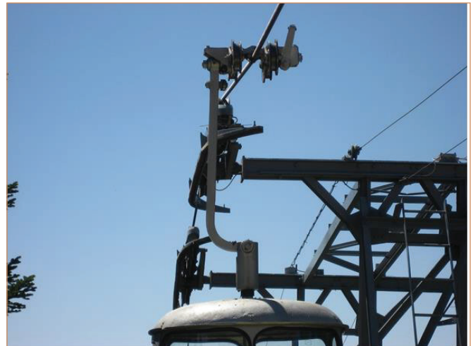
Fotoğraf 2. Telesiyej Sisteminin Hat Üzerindeki Bağlantı Durumu
