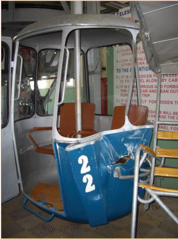
Fotoğraf 9. "22" Nolu Kapalı Kabinin Kaza Sonrası Sarıalan İstasyonundaki Durumu
