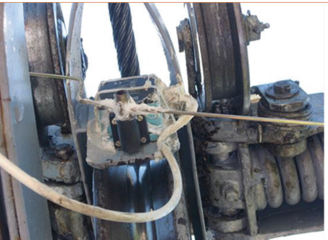
Fotoğraf 4. Taşıyıcı Direklerinde Bulunan Halat Düşmesi Durumunda Devreye Giren Aygıt
