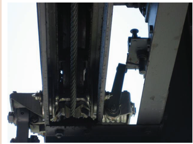
Fotoğraf 19. Kaza Deneme Çalışması Sırasında Kolun Sistemi Durdurması
