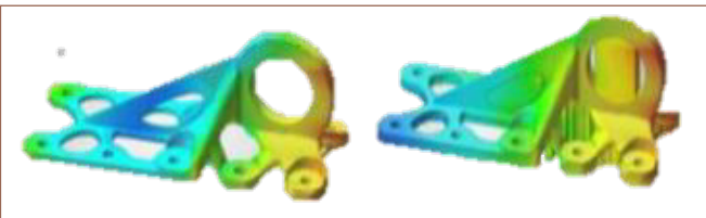
Şekil 6. Katmanlı İmalatta Destek Yapıyla İnşa [8]
