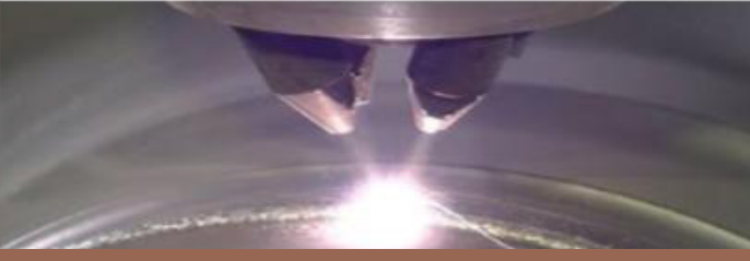
Şekil 5. Lazer ve Toz Üfleme Katmanlı İmalat Yöntemi [7]
