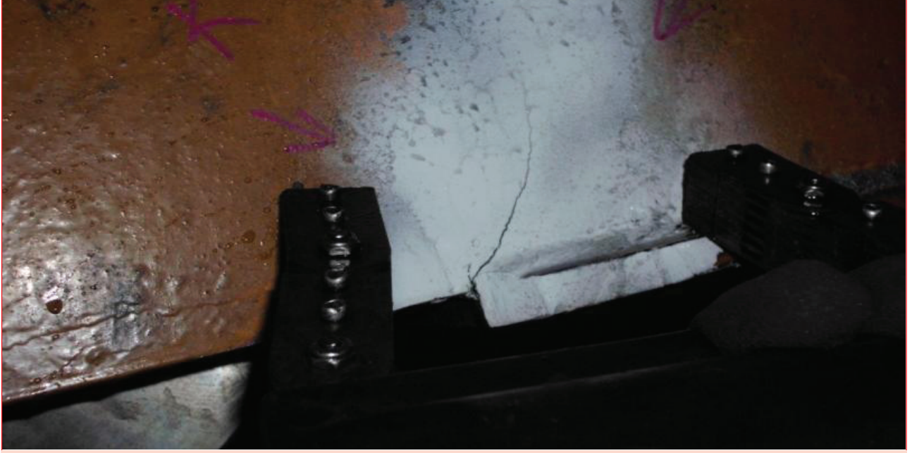
Fotograf 8. Vinç Konstrüksiyonu Yorulma Kontrolü Esnasında Manyetik Parçacık Testi ile Tespit Edilen Çatlak
