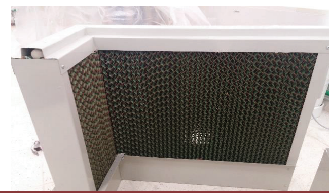
Şekil 5. Split Tip Klima Yoğuşturucusu İçin Tasarlanan Evaporatif Ped.(c) Kolektörler, (d) Boylerler
