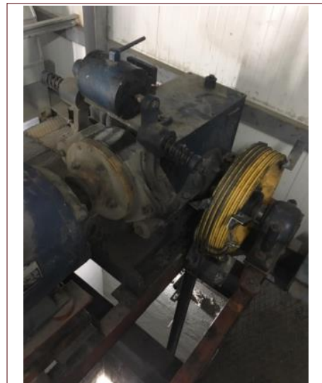
Fotoğraf 3. Halatlardan Birinin Atması ve Tozlanmanın Makina Motoru Üzerine Etkisi
