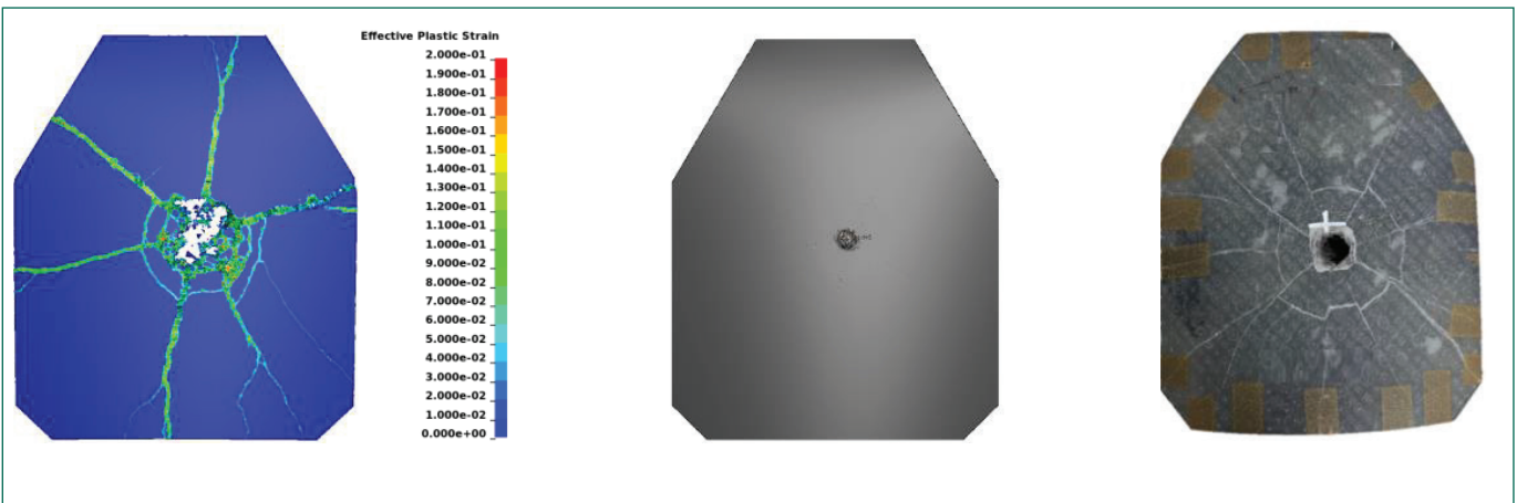
Şekil 1. Kusursuz Vücut Zırhının Terminal Balistik Çözümlemesinden ve Balistik Atış Testinden Sonra Oluşan Çatlak Örüntüleri
