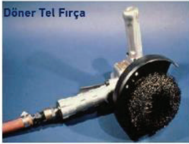
Döner tel fırça ile aşırı çalışma, kaplama adezyonu için zayıf bir profil çizen 'cılalı' bir yüzeye neden olabilir.
