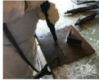
İğne Tabancası 'çekiçle dövülmüş' formda bir yüzey pürüzlülüğü yaratır
