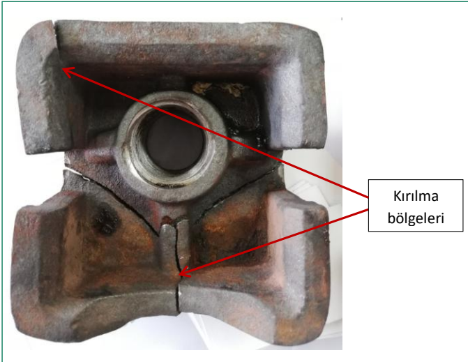
Fotoğraf 3. 1 Numaralı Ayak Döküm Parça Kırılma Bölgeleri
