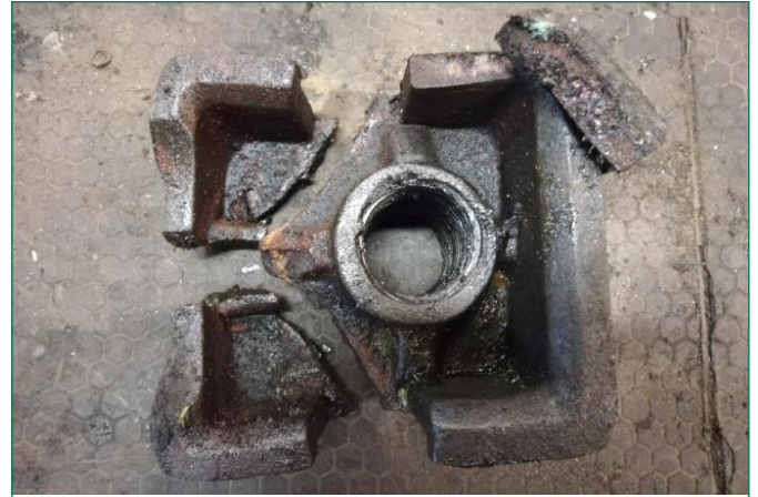
Fotoğraf 5. 1 Numaralı Ayak Döküm Parça Kırılma Bölgeleri
