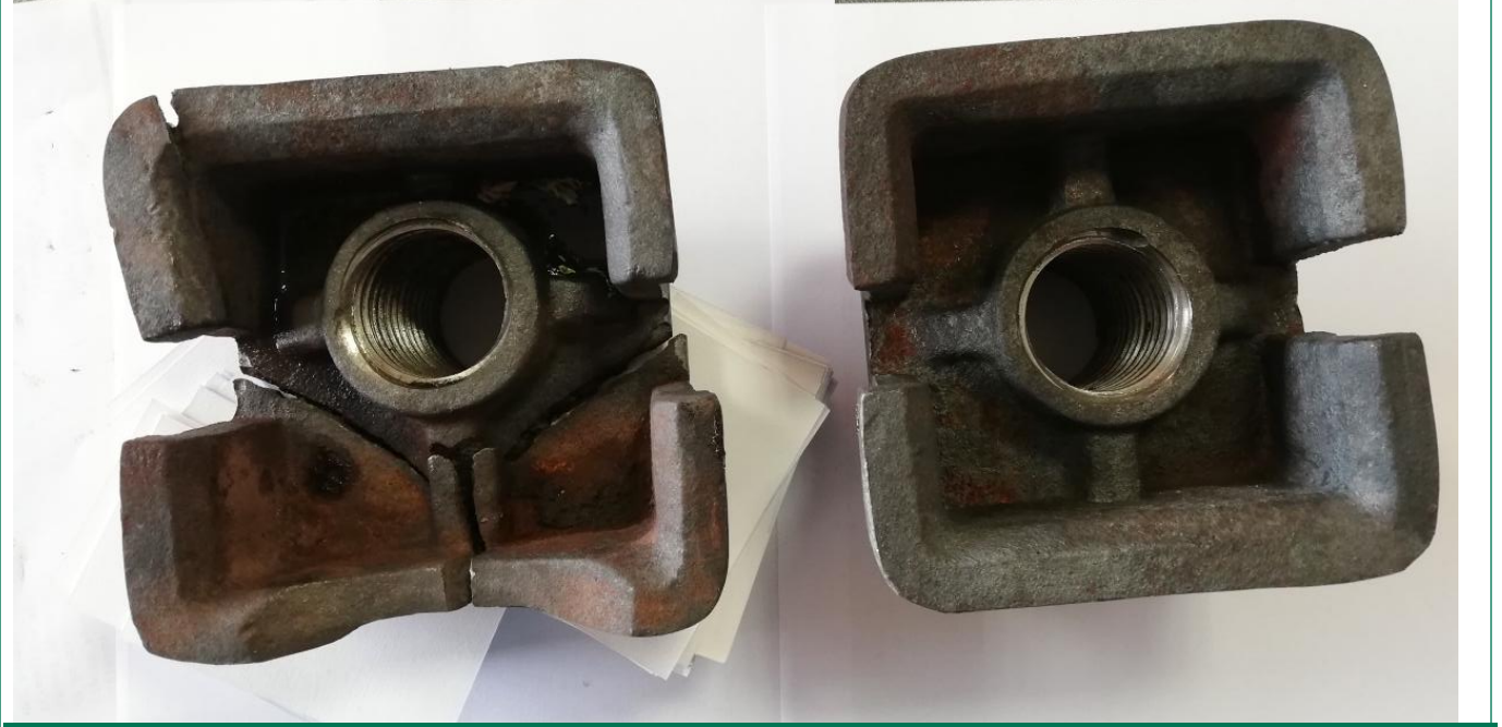
Fotoğraf 10. 1 ve 2 Numaralı Ayak Döküm Parça Ölçüsel Farklılığı
