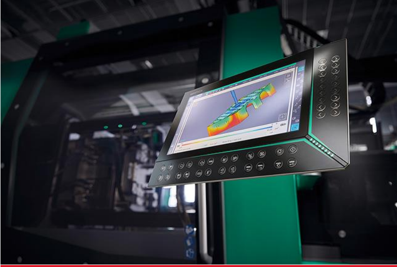
Resim 6. ARBURG Gestica Kontrol Ünitesinde Yapılan Bir Dolum Simülasyonu
