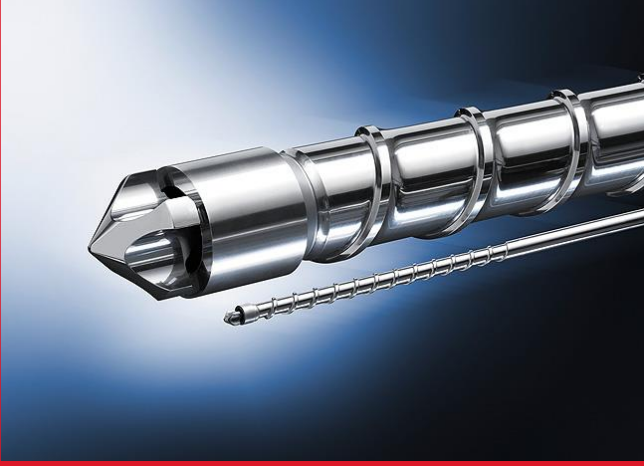
Resim 4. Vida Çapı Küçüldükçe, Aynı Miktarda Eriyik [cm 3 ] Hammaddeyi Kalıba Enjekte Etmek İçin Daha Yüksek Lineer Vida Hızı [mm/s] Gerekmetedir
