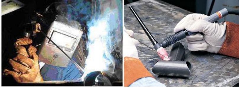
Şekil 2. Kaynak Yöntemleri [7] a) Elektrod Kaynağı b) TIG Kaynağı
