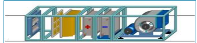
Şekil 1. Taze Havalı Klima Santrali
