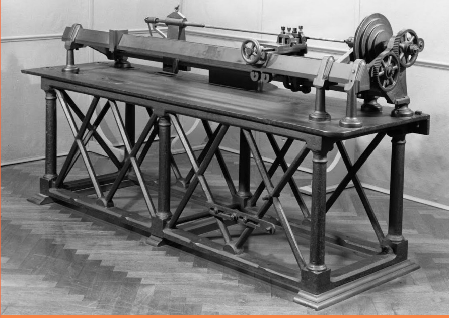
Şekil 1. Henry Maudslay Tarafından Geliştirilen Torna Tezgahı
