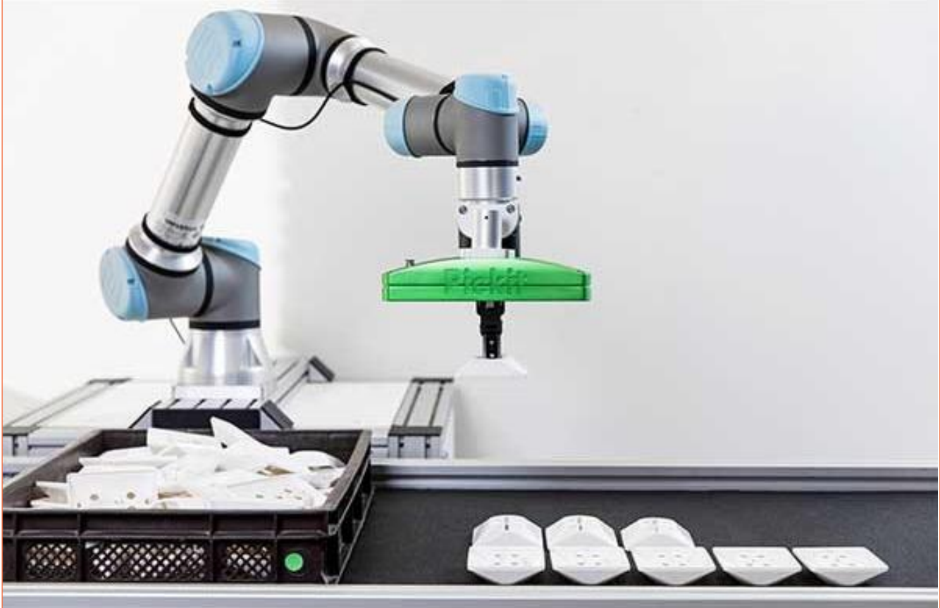
Şekil 9. 3 Boyutlu Kamera İle Kasa İçerisinde Karışık Duran Plastik Parçaların Üretim Hattına Beslenmesi
