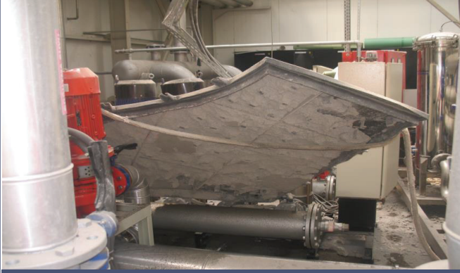
Fotoğraf 16. Sol Kapağın Patlama Sonrası Durabildiği Yer
