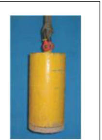
Resim 5. Deneyde Kullanılan Yumuşak Yüzeyle, Kenarları Keskin Olmayan Silindirik Parça
