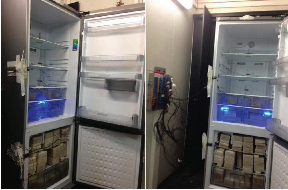
Şekil 8. VYP Uygulanmış Buzdolabı Enerji Testleri Ölçüm Noktaları
