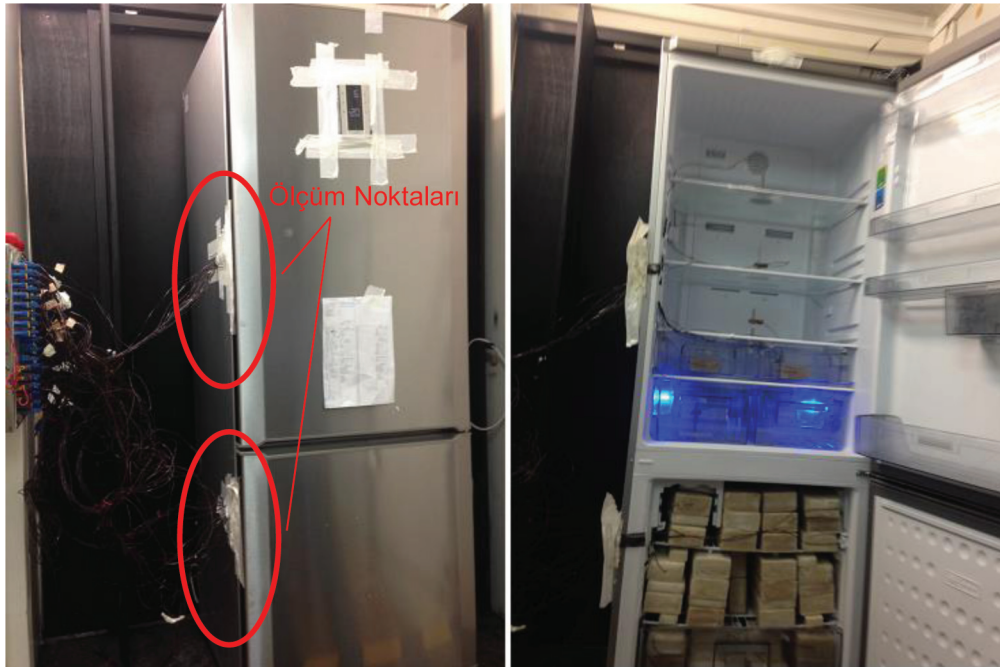
Şekil 7. VYP Uygulanmamış Standart Buzdolabı Enerji Testleri
