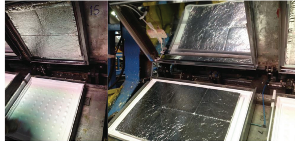
Şekil 4. VYP'lerinin Buzdolabı Kapağına Uygulanması
