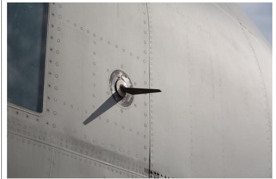
Şekil 3. Uçağın Her İki Tarafında Bulunan AoA Sensörü
