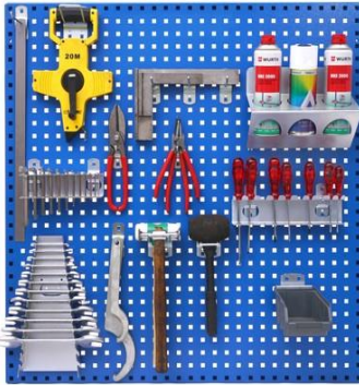
Şekil 5. Alet için Takım Asma Panosu (Starçelik, 1976)
