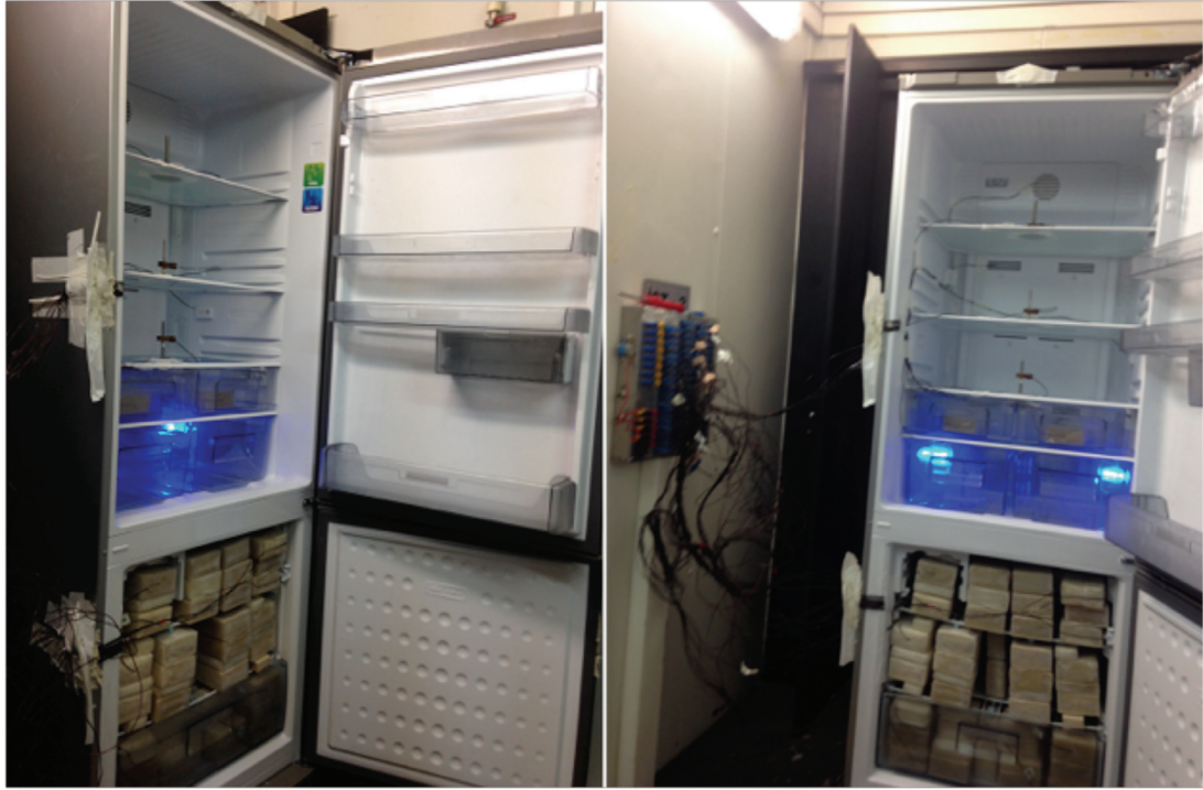
Şekil 8. VYP Uygulanmış Buzdolabı Enerji Testleri
