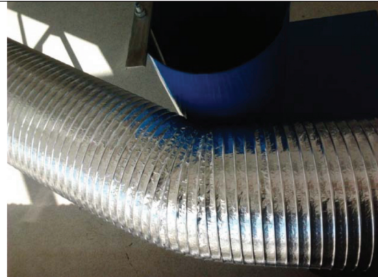
Şekil 3. (a) %15 Sıkıştırılmış ve (b) 30° Bükülme Açılı Esnek Kanalların Görünüşü
