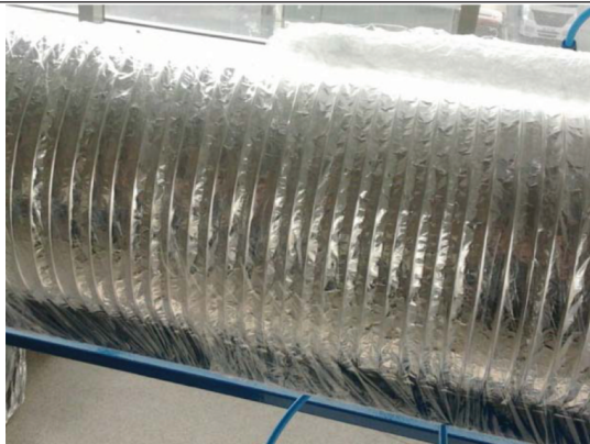
Şekil 3. (a) %15 Sıkıştırılmış ve (b) 30° Bükülme Açılı Esnek Kanalların Görünüşü
