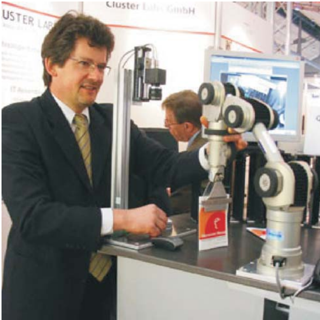
Resim yazısı: Neuronics AG'den Werner Klecka, güvenlik bariyeri olmadan insanların yanında çalışması için tasarlanan küçük bir robotu sunmaktadır. Robotun ağırlığı 4 kg kadardır.
