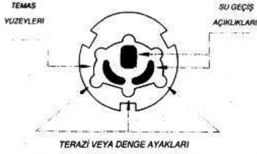
ŞEKİL 2. Seramik aynalar arasındaki temas ya da deşinim alanının azaltılmasına olanak veren terazi ayaklı "Örümcek Tekniđi" uygulamasına ilişkin prensip şeması.
