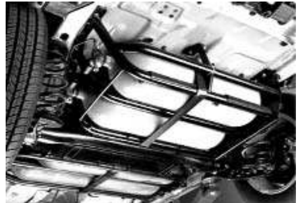
Şekil 6. Döşeme altına yerleştirilmiş basınç tüpleri
