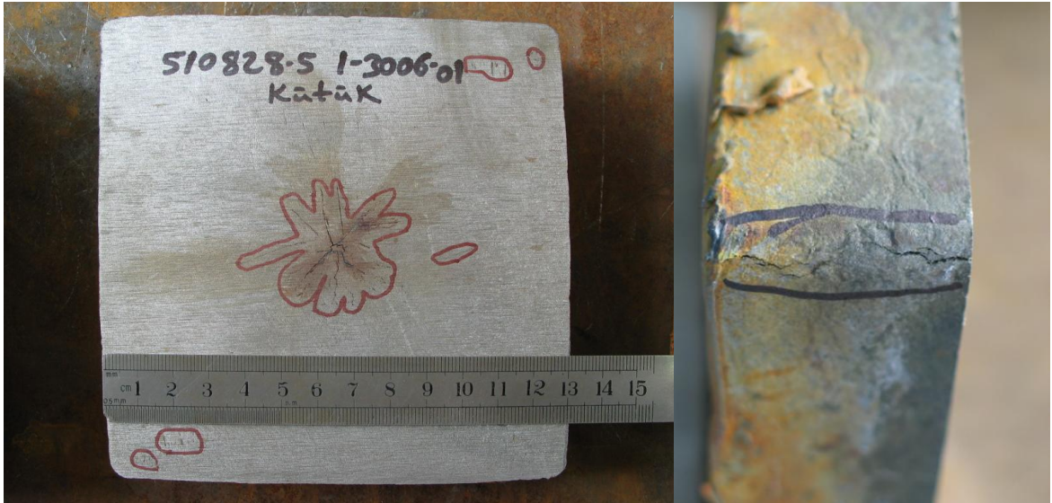
Şekil 5. 1.3006_01 Kalite dökümlere ait sıcak asitle dağlanmış makro numuneleri (kenar)
