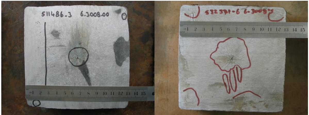
Şekil 6. 6.3008_00 Kalite dökümlere ait sıcak asitle dağlanmış makro numuneleri
