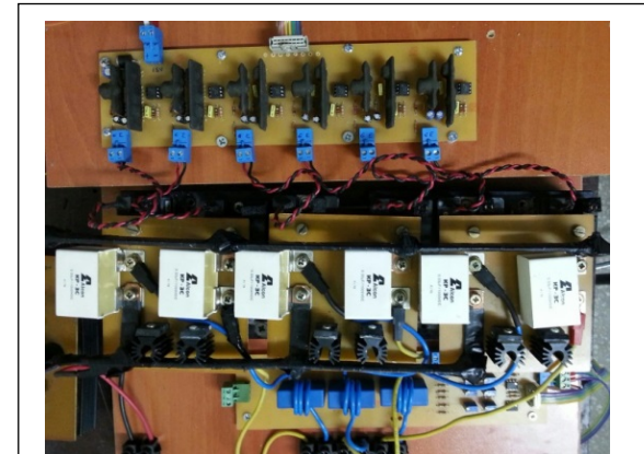
Şekil 14. Üç Fazlı Klasik Bir LARM Sürme Devresi
