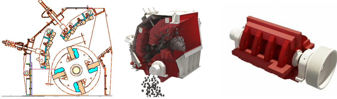
Şekil 4: Sekonder Darbeli Kırıcı İç yapısı
