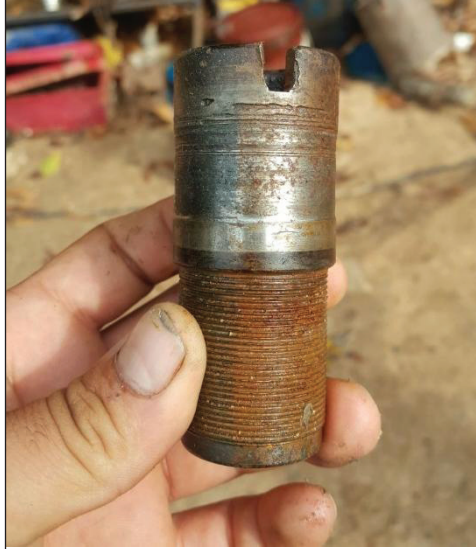
Şekil 6. Servis Ömrünü Tamamlamış Borlanmış Araparça
