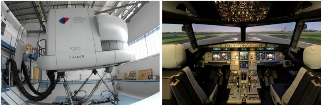
Şekil 1, 2: A320 Tam uçuş simülörü (THALES) – JAR STD 1A Seviye D [2]
